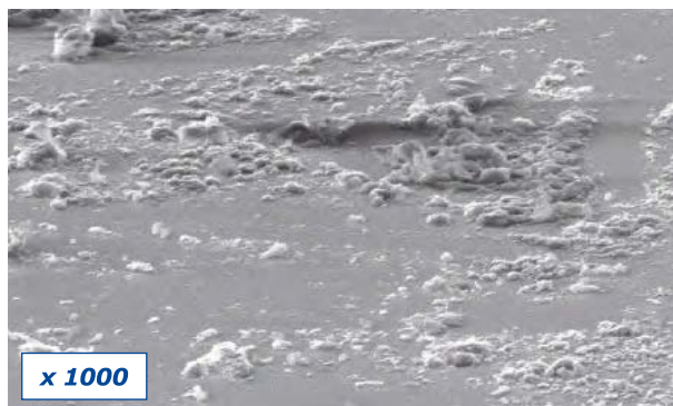
Vergrößerung eines herkömmlichen Duschkabinglases nach täglicher Benutzung: Raue Stellen sind deutlich sichtbar.
