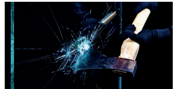
Abb. 7.4: Durchbruchversuch mit Axt
