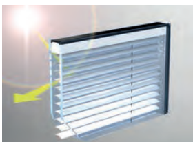
Abb. 6.2: Jalousie-System im Isolierglas
